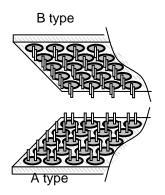
Fig.4-2 ホルダーを重ね合わせる HolderA(B) superpose on HolderB(A).
